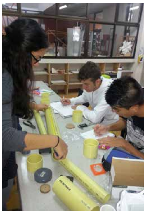
Figura 5. Semillero SeDisTec fabricando el tubo de impedancia acústica Antara. Fuente: Gustavo Adolfo Peña Marín
