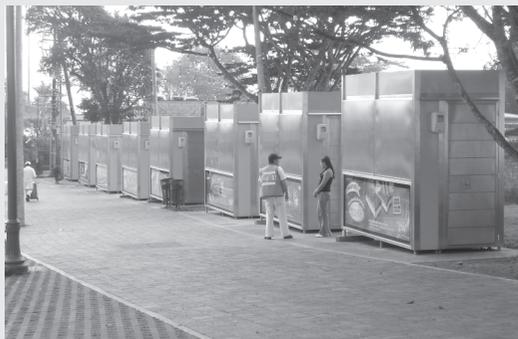
**IMAGEN 2:** El módulo tipo B tiene una altura de 2.60 metros, 3 metros de ancho y 1.50 de profundidad, a diferencia del módulo tipo A, el vendedor puede estar en su interior, haciendo que éste le proporcione una mayor protección ante los cambios climáticos.
