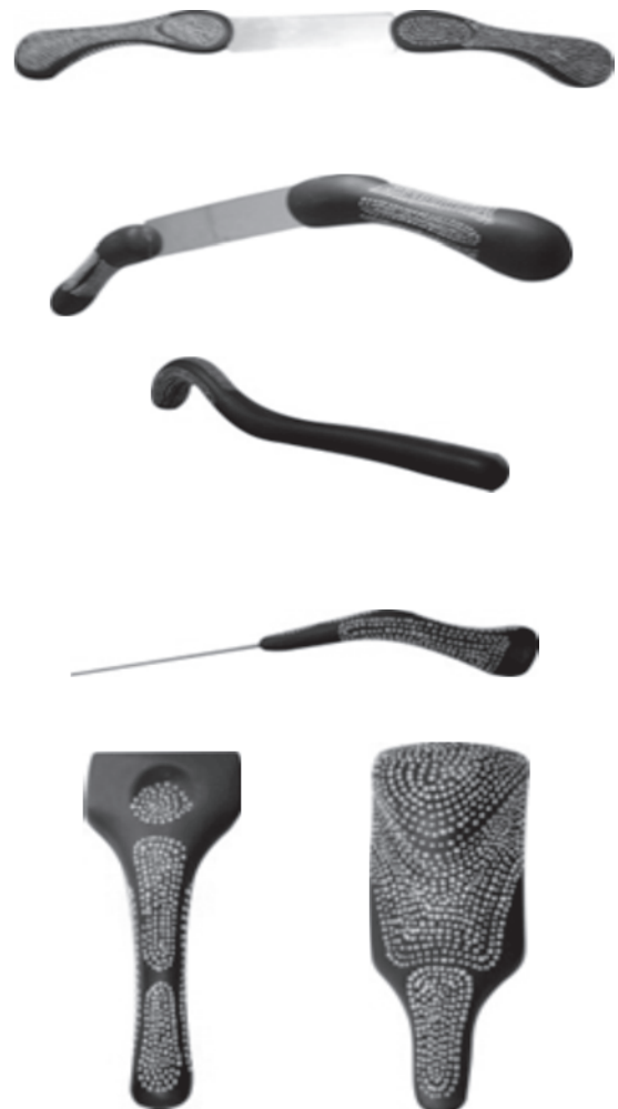
Figura 3. Prototipos de las herramientas diseñadas para el pelado (Izq.) y lijado (Der.) de la guadua en su capa interna y externa
