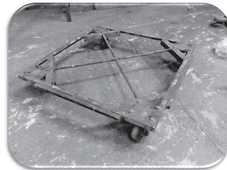
Figura 4. Elemento utilizado en el transporte de producto o rotación de 360°, dependiente del eje.
