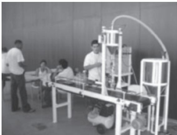
Figura 9. Vista general de la embotelladora
