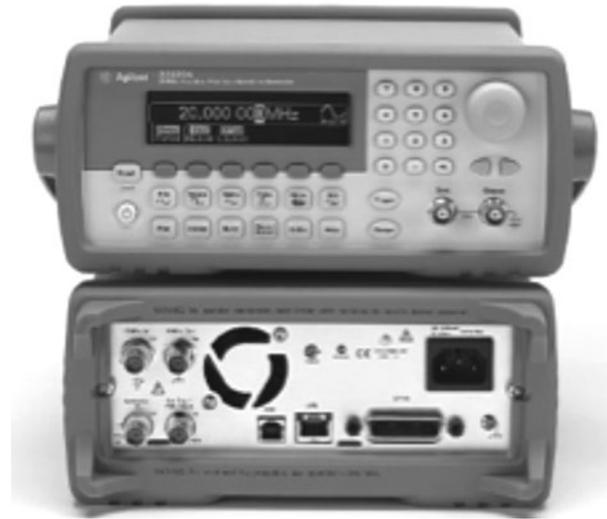
Fig. 1. Panel frontal y panel posterior del generador de onda arbitraria 33220A de Agilent Technologies.
