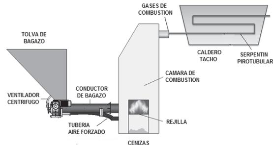
Fig. 10. Diseño del sistema de generación y transferencia de calor del quemador de biomasa.
