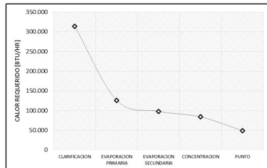
Fig. 6. Gráfica de requerimiento de calor [BTU/hr] en cada una de las etapas de evaporación y concentración del jugo.
