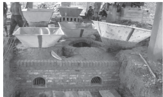
Fig. 5. Fotografía de la hornilla tradicional, muestra la forma en la cual se ubican los calderos sobre la hornilla.
