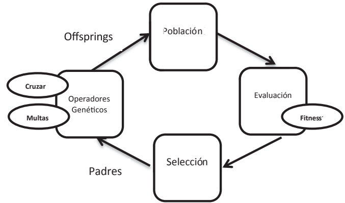
Fig. 1. Ciclo de Algoritmo Evolutivo (adaptado de [2]). A una población de 'n' individuos se aplica una evaluación para determinar los mejores individuos en función de la aptitud o fitness. De estos mejores individuos se aplica una selección para determinar los individuos que serán elegidos como padres, haciendo que se reproduzcan con ayuda de los operadores genéticos. Estos causan una serie de transformaciones de alteración y recombinación en los individuos, para generar los descendientes. Este ciclo se repite hasta conseguir hacer evolucionar la población.
