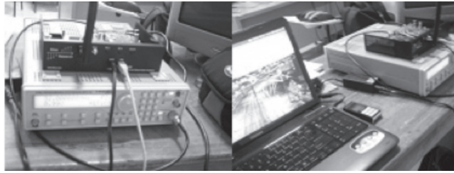
Fig. 4. Disposición de equipos para las pruebas de la medición: generador y USRP1, PC, terminal móvil. Fuente: Autores
