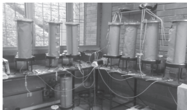
Fig. 3. Montaje final del sistema de biorremediación
