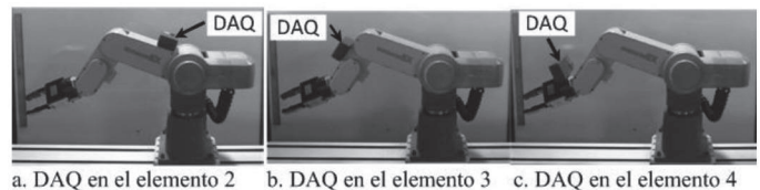
Fig. 6. Montaje de DAQ en los eslabones del robot RV-M1.
