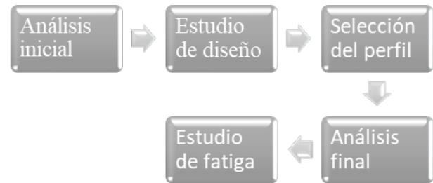
Fig. 4. Diagrama de flujo del proceso de análisis de elementos finitos en SolidWorks 2015®.
