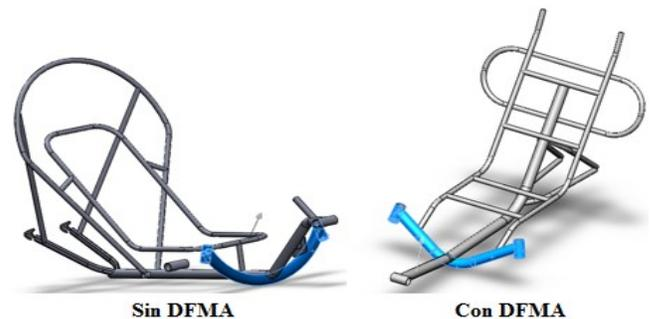
Fig. 14. Muestra la comparación del tren delantero del primer diseño (sin DFMA) y del diseño con DFMA, en donde se redujo la longitud de arco del doblado.
