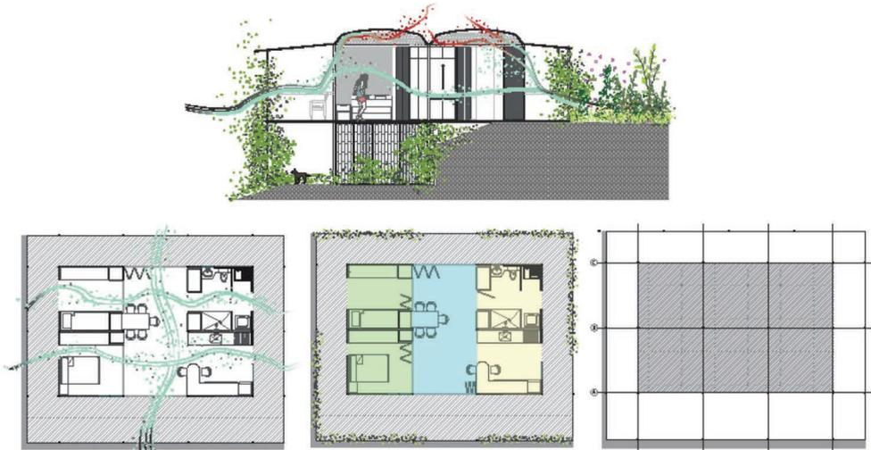
**Fig.2.** Sección y planta con esquemas bioclimáticos. Planta de las áreas funcionales (en verde las habitaciones, en azul el espacio común y en rosa cocina, baño y lavandería). Planta de la estructura modular.
