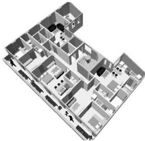
Figura 14. Distribución arquitectónica para el piso tipo de los últimos dos niveles del Edificio.
